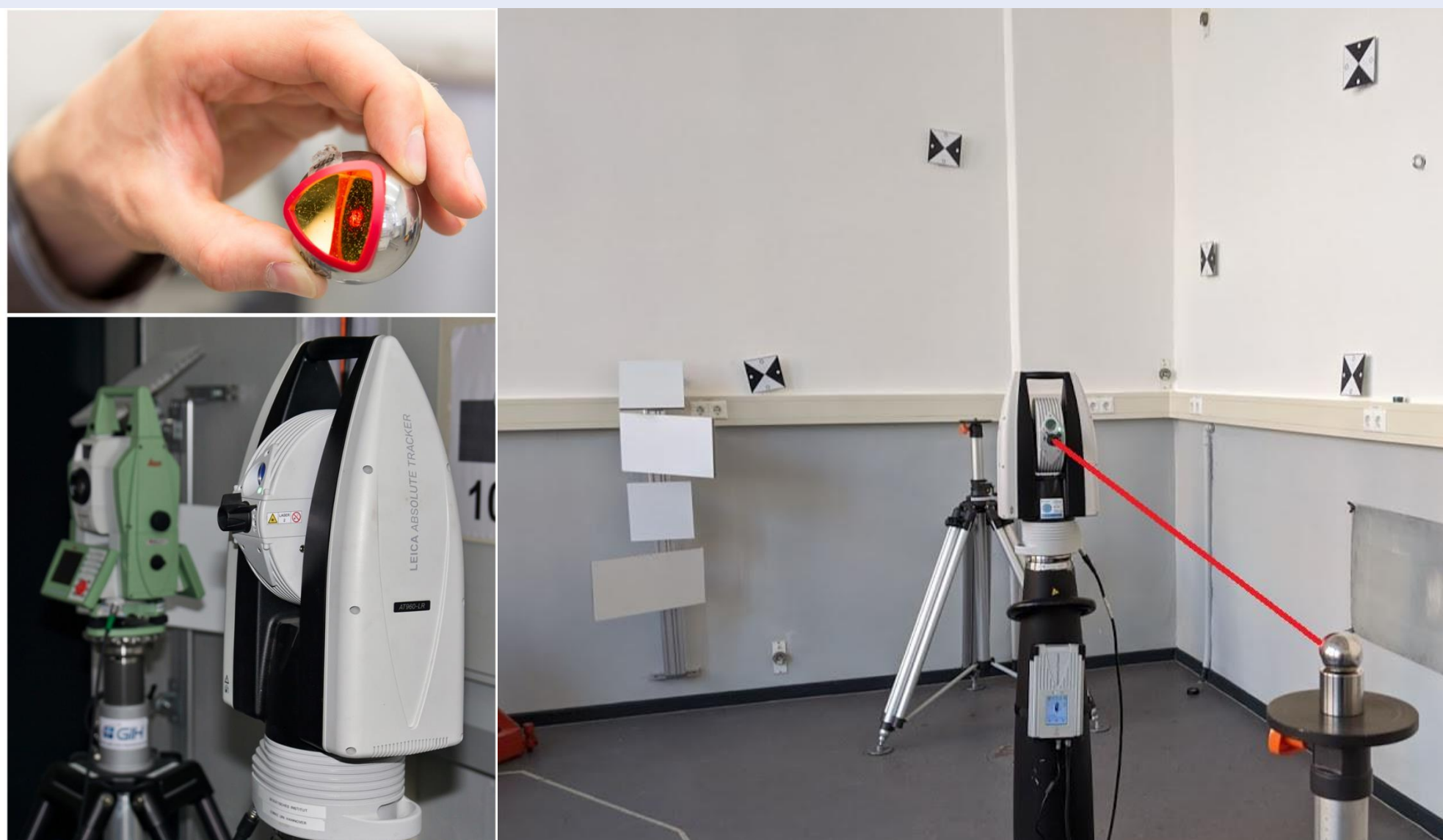
Abb. 1 Hochgenaue Streckenmessung mit Lasertracker und Corner-Cube-Reflektor im 3D-Labor des GIH
